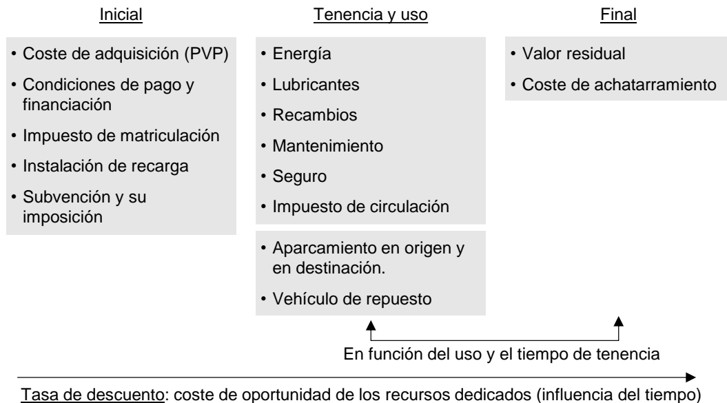
Figura 70: Elementos del Coste Total de Propiedad (TCO). Fuente: Elaboración propia a partir de Franzò et al., 2022, Liu et al., 2021, E-Mobility Solutions, 2022 y European Alternative Fuels Observatory (EAFO) 49 .
